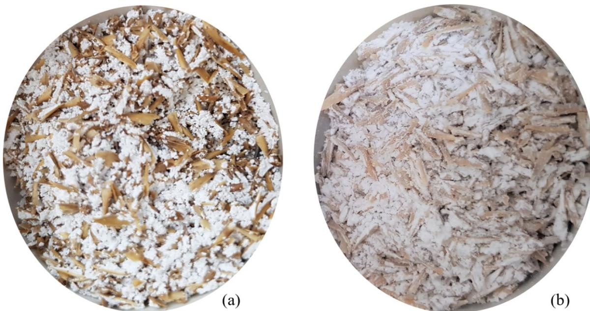
Figura 3.4 – Biomassa preparada com aplicação do catalisador *in situ*. (a) biomassa com o catalisador básico (hidrocalumita); (b) biomassa com o catalisador ácido (zeólita HZSM-5).
