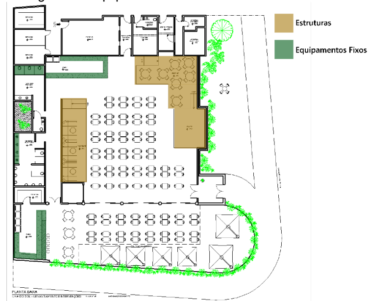
Figura 71: Equipamentos e estruturas fixas Café Aruba.
