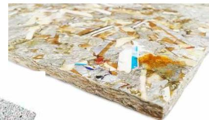
Fig. 62: composição da chapa ecológica. (Fonte: site Ecopex).
