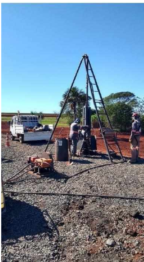
Figura 14: (a) Perfuração do furo de sondagem; (b) Descida da célula de indicador de nível d'água.
