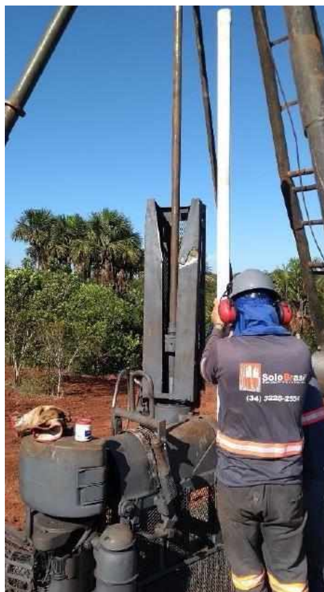
Figura 14: (a) Perfuração do furo de sondagem; (b) Descida da célula de indicador de nível d'água.
