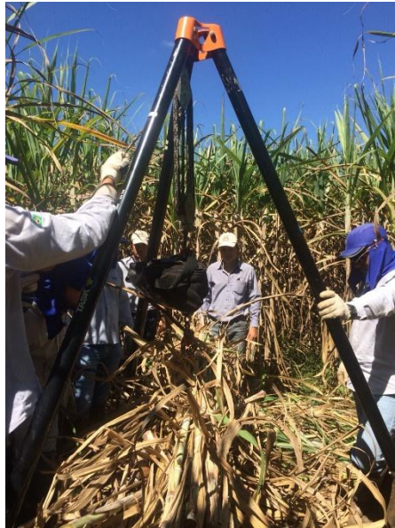
Figura 4. Pesagem da cana-de-açúcar colhida com o auxílio de uma balança acoplada a um tripé de sustentação
