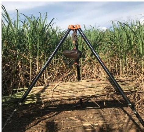
**Figura 2.** Balança acoplada a um tripé. Fonte: GPSI, 2018
