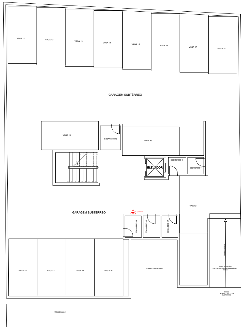
POSICIONAMENTO DE EXTINTORES - SUBTÉRREO
