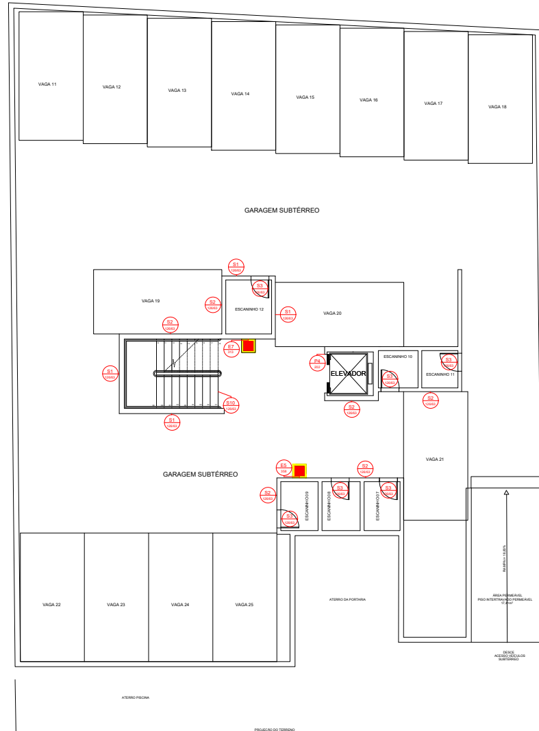
SINALIZAÇÃO DE EMERGÊNCIA - SUBTÉRREO
