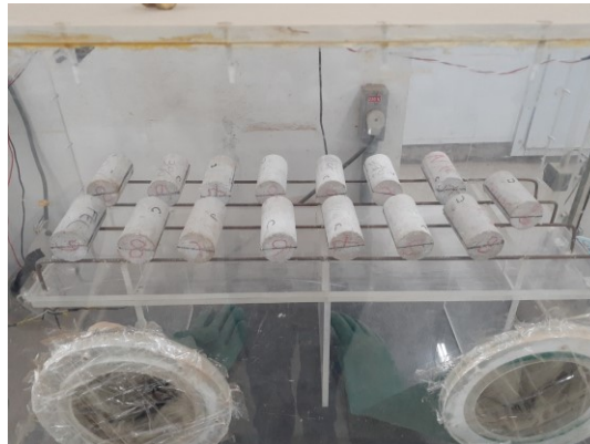
Figura 4 - Posicionamento dos CP's na câmara de carbonatação.
