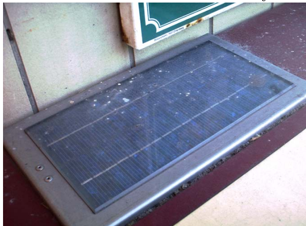
Figura 18 – O módulo fotovoltaico sombreado e sujo da máquina.
