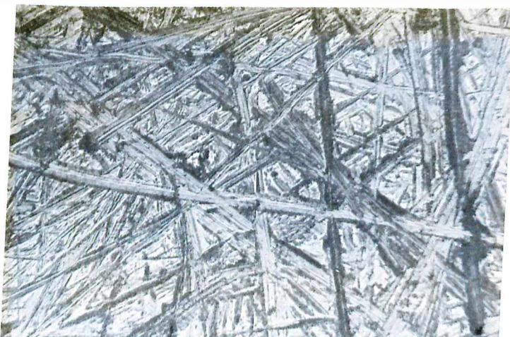
Figura 32 - Micrografia da amostra TS-Y; pressão = 3,841 N/mm 2 , tamanho do abrasivo = 180 μm, aumento = 120 X.
