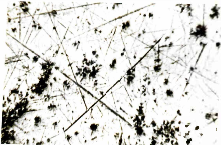
Figura 31 - Micrografia da amostra TS-Ce; pressão = 1,272 N/mm 2 , tamanho do abrasivo=25,75 μm, aum.=120 X.
