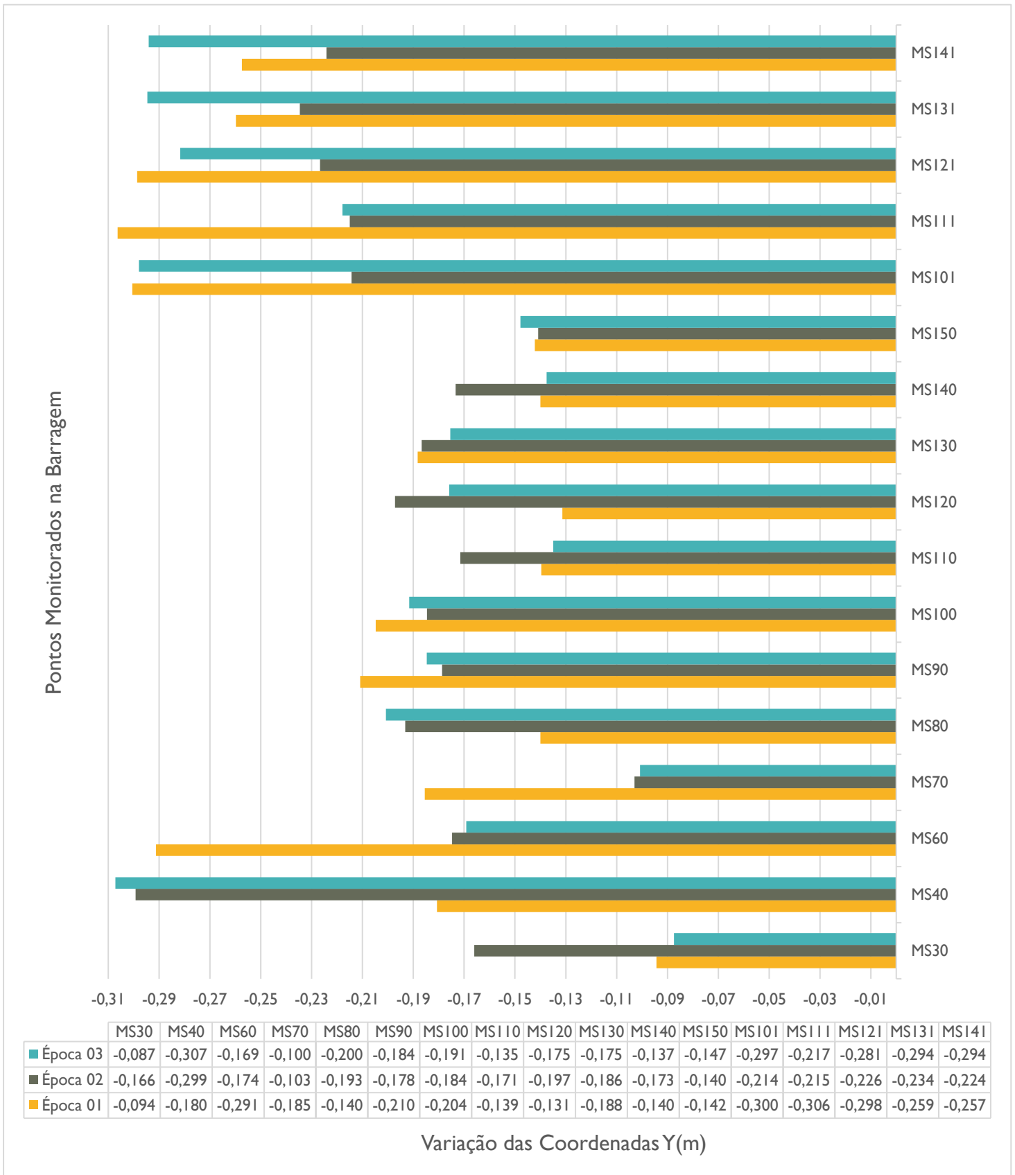
Gráfico 4 – Variação das coordenadas para a componente 4 das Épocas 1, 2 e 3 em relação à Época CEMIG para os pontos monitorados
