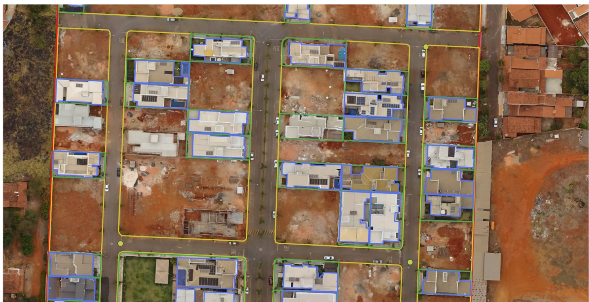
Figura 09 – Vetorização de área construída, lote e quadra
