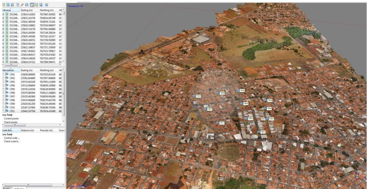
Figura 08 – Distribuição dos pontos de controle
