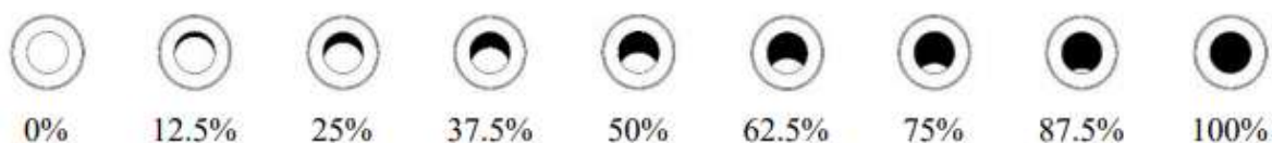
Figura 2.3 - Comparativo entre diferentes porcentagens de fechamento de uma válvula gaveta (Sotomayor, 2016)
