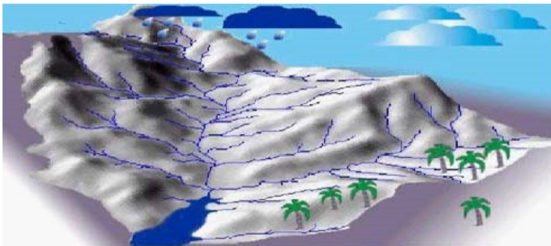
Figura 1: Ilustração de uma bacia hidrográfica mostrando os divisores de água, as sub-bacias e a drenagem principal.
