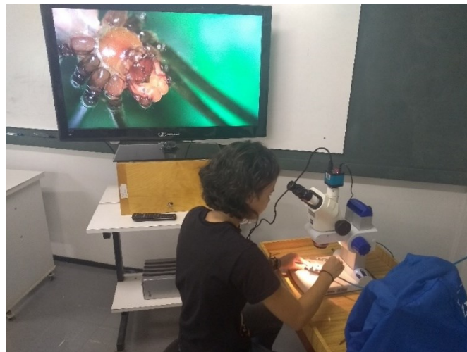
Figura 3: processo de retirada das cerdas retro-laterais com o auxílio da lupa estereoscópica conectada à televisão.
