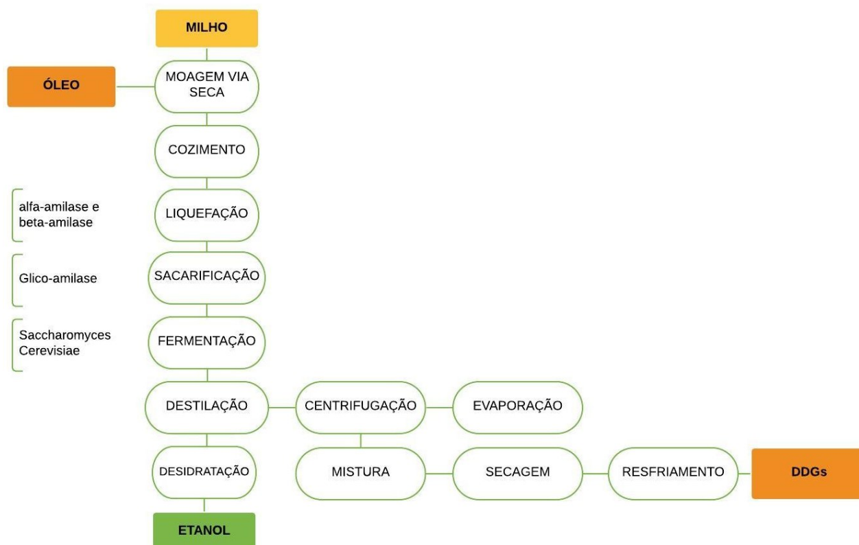
Figura 2 - Etapas de Produção de etanol de milho por via seca.
