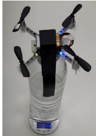
Figura 4.9 – Ensaio para a obtenção do coeficiente de empuxo.
