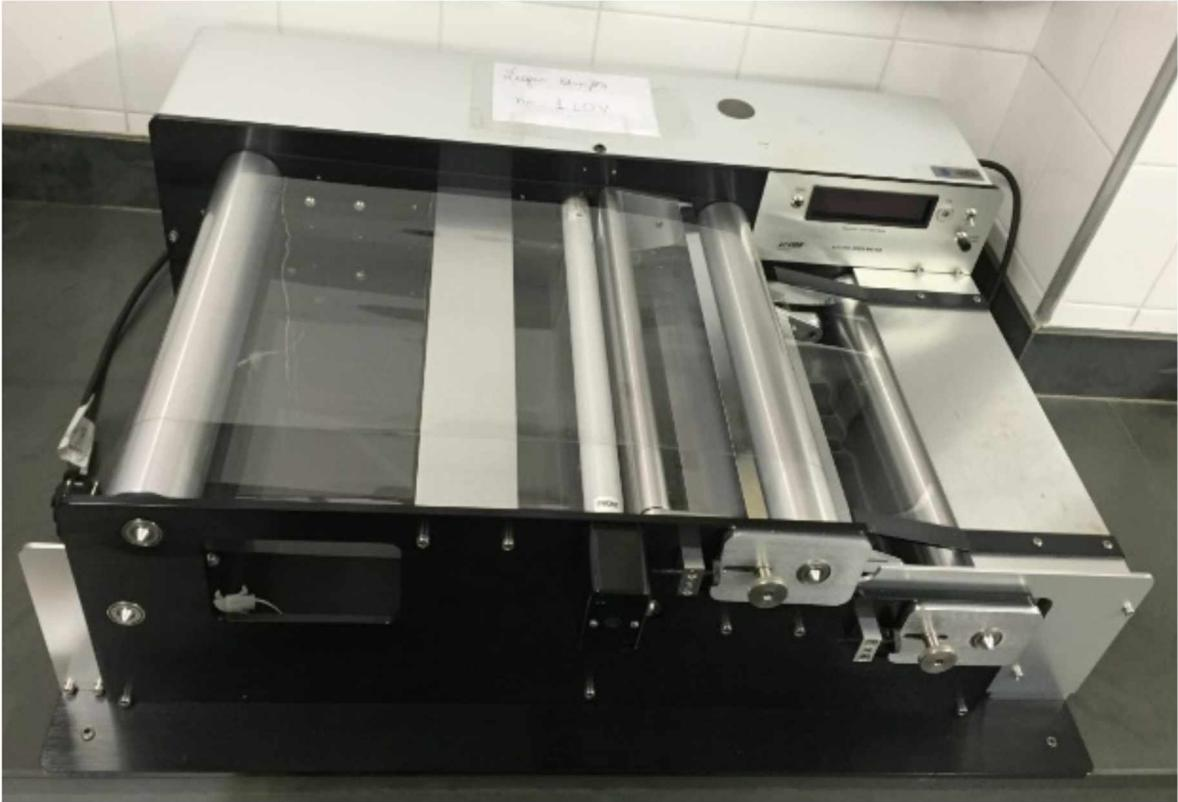
**Figura 2.** Aparelho LI-COR 3100, localizado no Laboratório de Mecanização da Universidade Federal de Uberlândia. As amostras são corridas pelo rolo plástico à medida que o aparelho realiza a leitura da área foliar.
