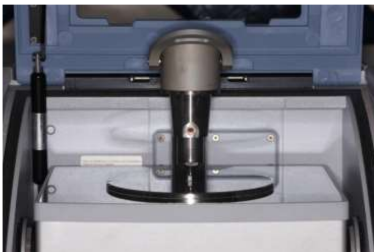
Figura 3 - Amostra posicionada sobre o cristal do equipamento para leitura.
