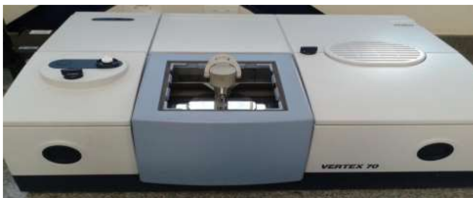
Figura 2 - Espectrômetro Infravermelho com Transformada de Fourier, com dispositivo ATR (Vertex 70, Bruker).
