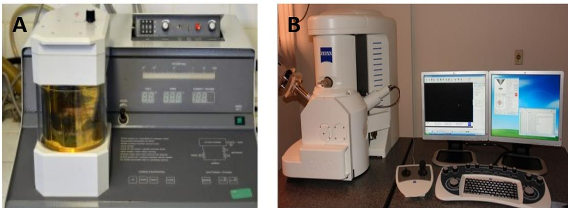
**Figura 7:** A – Metalizador. B - Microscópio Eletrônico De Varredura
