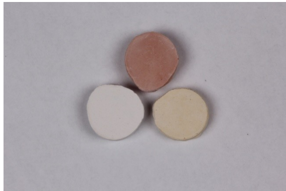
Figura 9: Amostras de gesso utilizadas no teste de rugosidade superficial
