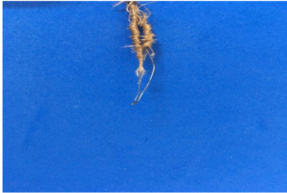
Figura 5: Termopar do tipo T cobre-constantan
