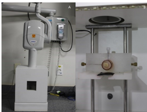
Figura 2 – A: Equipamento de raio-x digital. B: Dente e filme posicionados perpendicularmente ao eixo do cabeçote para incidência da radiação.
