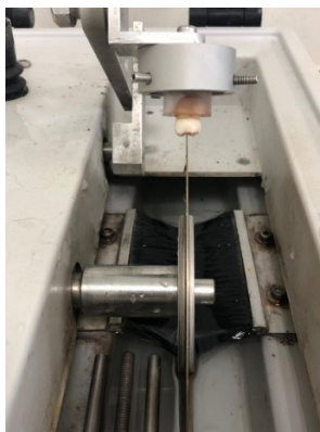
Figura 3 - Amostra sendo cortada na cortadeira de precisão.
