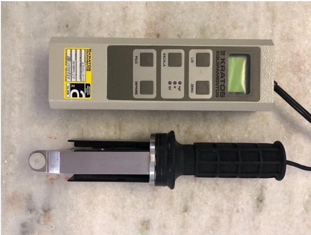
Figura 2- Gnatodinanômetro equipamento industrial Kratos LTDA, Cotia, SP
