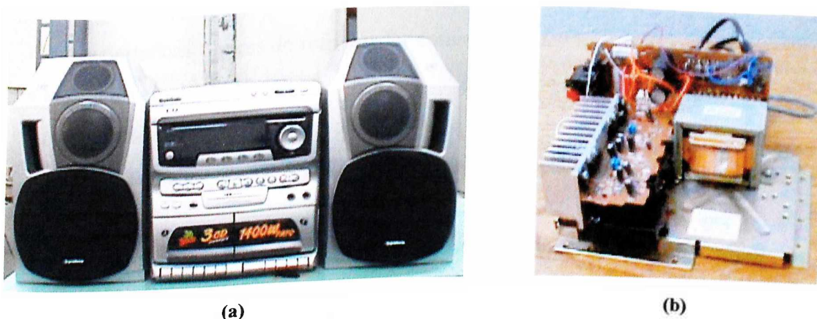
Fig. 5.6. Aparelho de som: (a) vista externa; (b) vista interna da fonte linear regulada.
