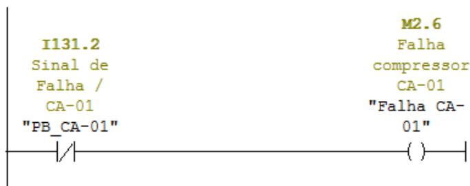
Figura 24- Lógica Alarme Compressor 02
