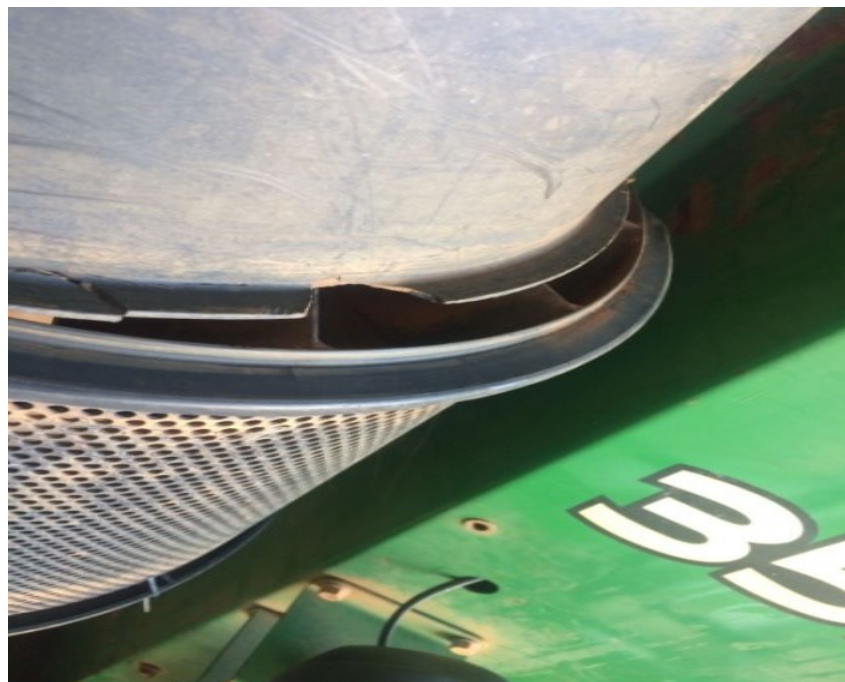
Figura 6 – Quebra de uma parte do filtro do sistema de admissão
