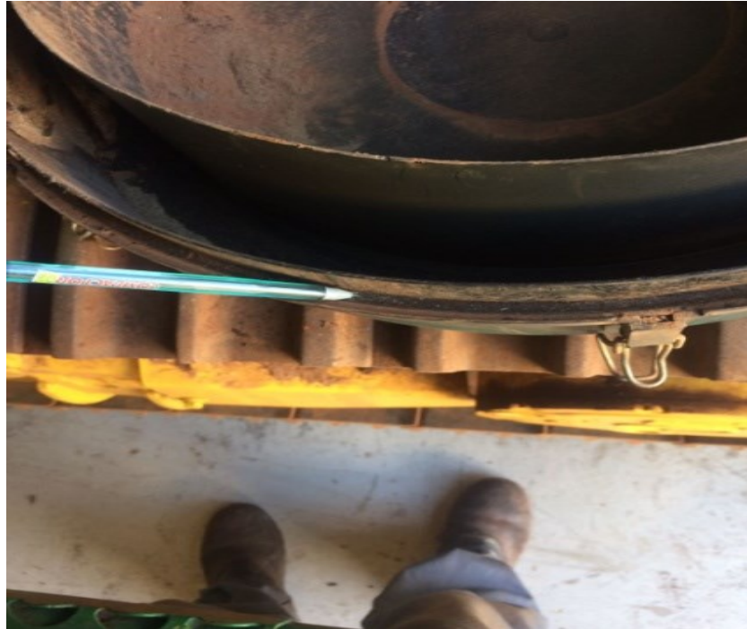
Figura 5 – Entrada de impurezas no sistema de admissão devido ao ressecamento e má colocação
