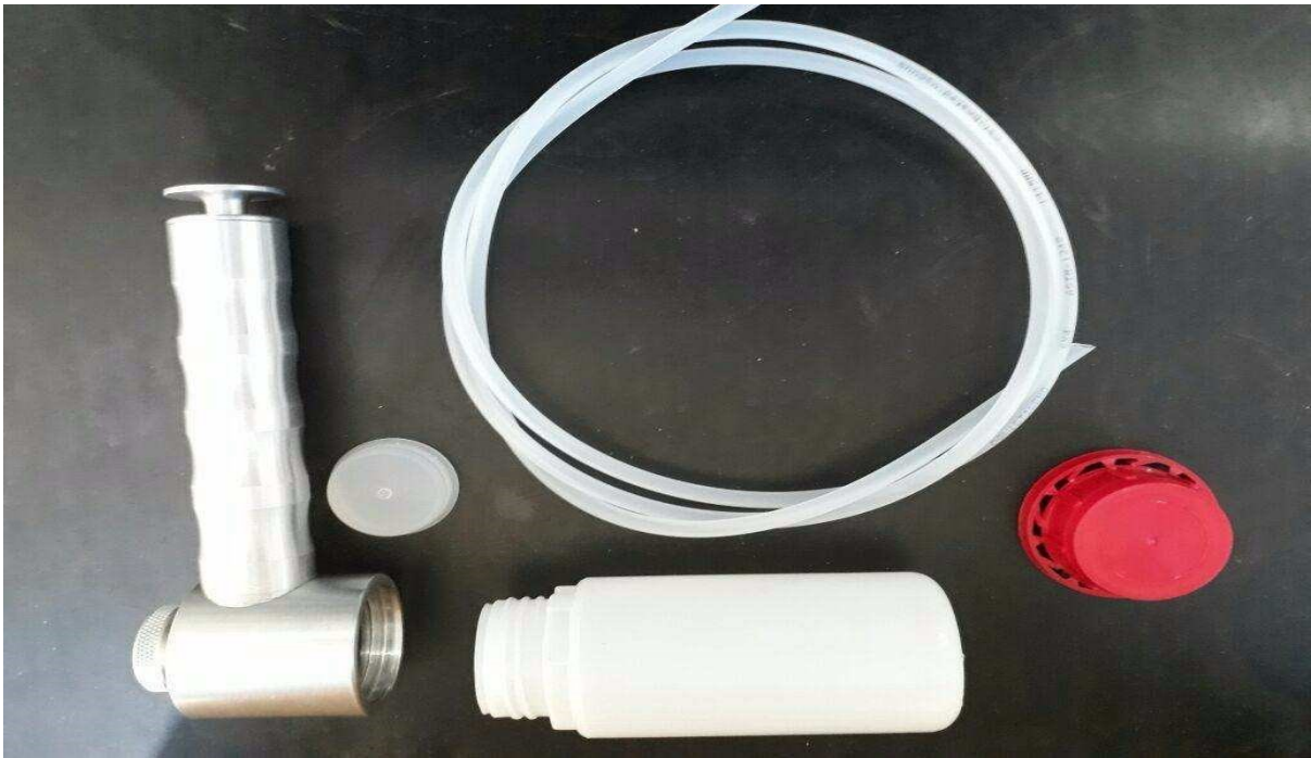
Figura 3 – Kit utilizado para coleta de amostras de óleo lubrificante
