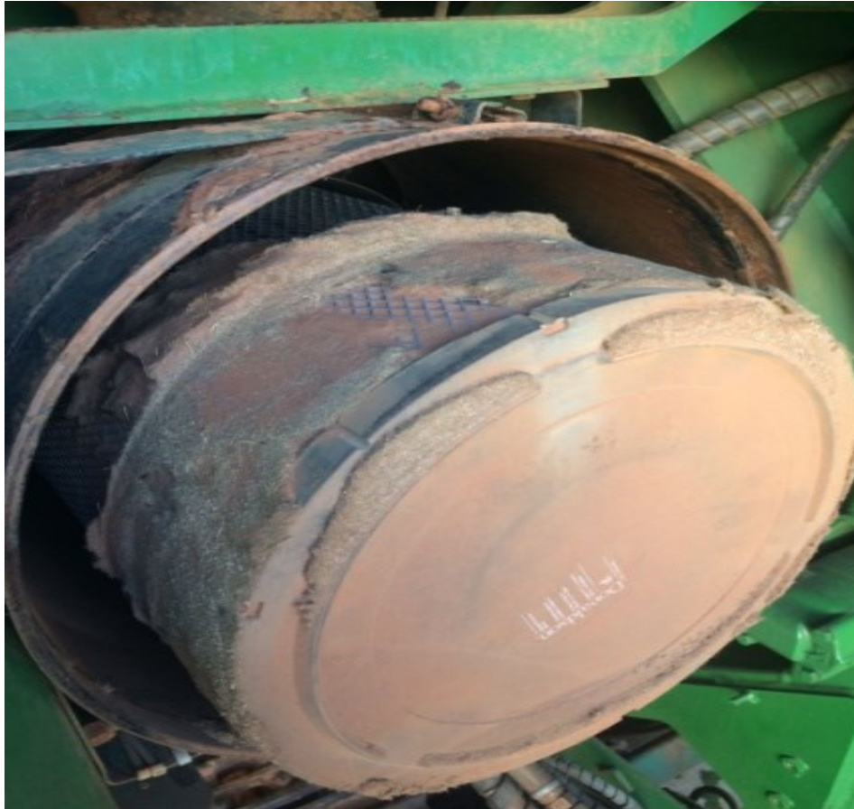
Figura 7 – Impurezas encontradas no filtro do sistema de admissão
