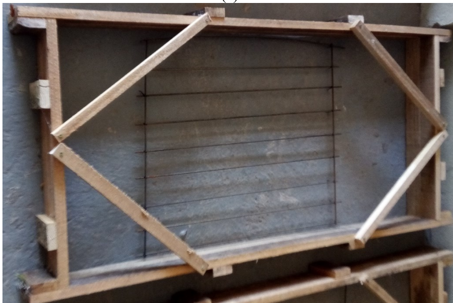
Figura 33 - Armaduras de longitudinais: (a) 0% ; (b) A_{s,min} ; (c) 2 \times A_{s,min} . (a)
