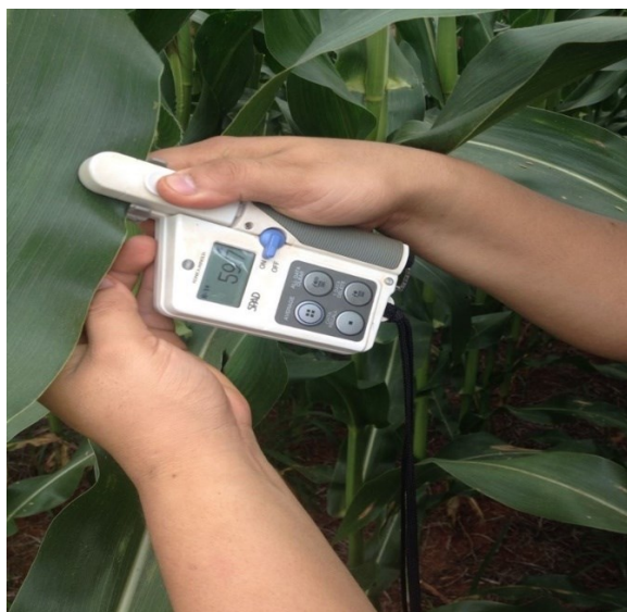
Figura 18. Determinação do Índice SPAD com o uso do Clorofilômetro Konica Minolta SPAD no milho.
