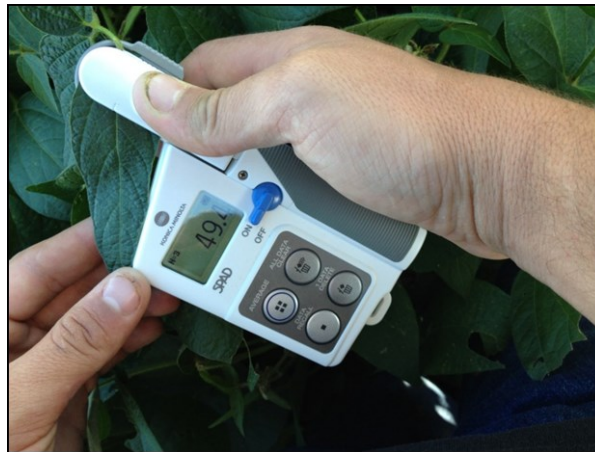
Figura 7. Clorofilômetro Konica Minolta SPAD utilizado para a leitura do índice SPAD na soja.
