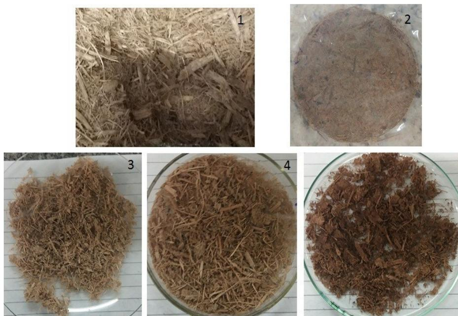
**Fonte:** Autora. (1 - Bagaço de cana *in natura*; 2 - bagaço pré-tratado: amostra 2; 3 - bagaço pré-tratado: amostra 5; 4 - bagaço pré-tratado: amostra 15; 5 - bagaço pré-tratado: amostra 17).
