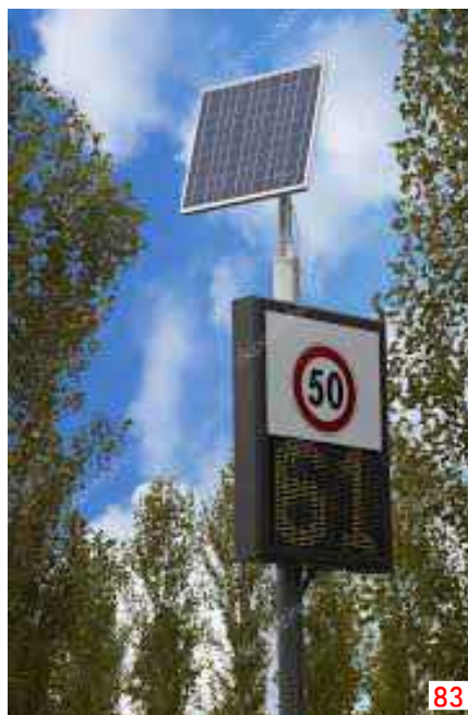
Radar de velocidade alimentado por painel solar. Disponível em: < https://bit.ly/2WSQncC >
