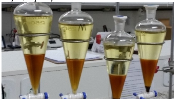
Figura 17 - Etapa de decantação, separação do biodiesel de óleo de amêndoa de macaúba da glicerina
