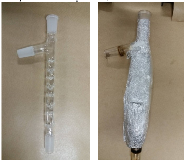
Figura 24 - Coluna de destilação utilizada no processo, sem e com o isolamento
