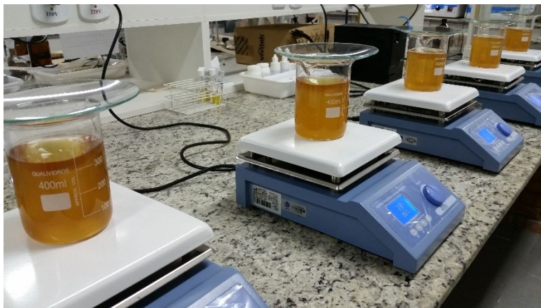
Figura 15 - Produção de biodiesel através de transesterificação metílica de óleo de amêndoa de macaúba
