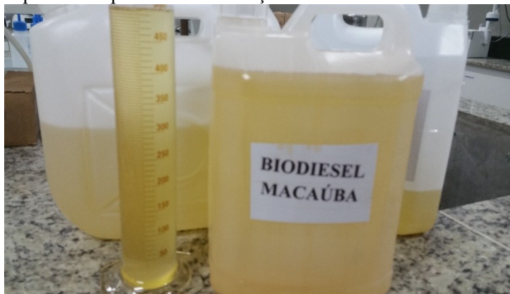
Figura 28 - Biodiesel produzido por transesterificação metílica de óleo de amêndoa de macaúba
