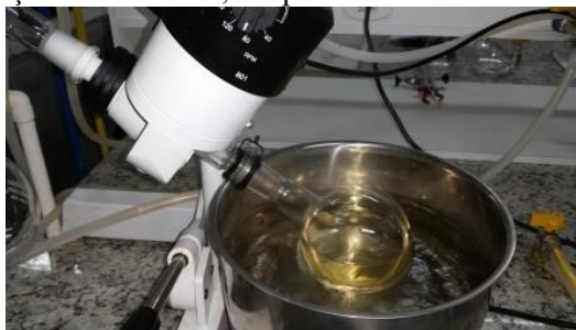
Figura 19 - Etapa de purificação do biodiesel, evaporador rotativo
