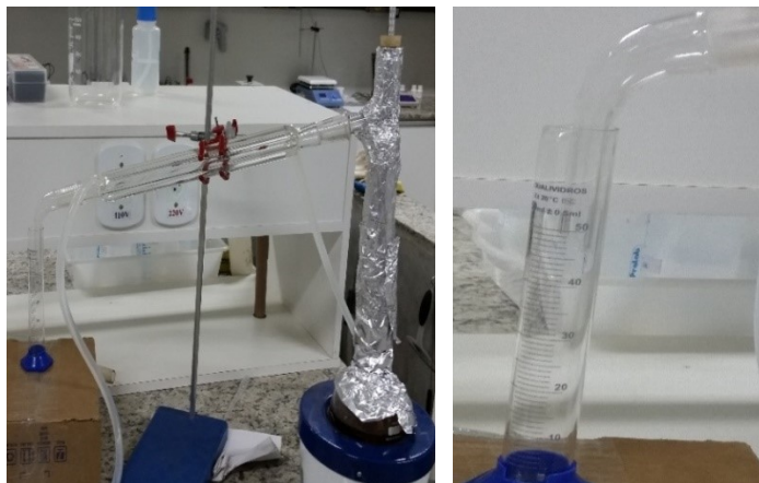
Figura 25 - Destilação do biodiesel separado em frações, para posterior análise do teor de ésteres
