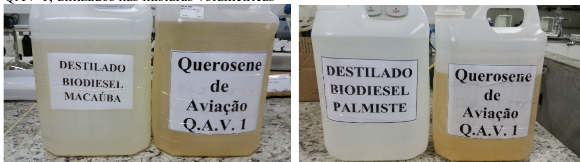
Figura 34 - Destilados dos biodieseis de amêndoa de macaúba e palmiste e o querosene de aviação QAV-1, utilizados nas misturas volumétricas
