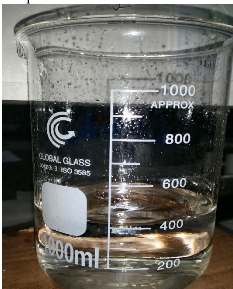
Figura 31 - Destilado do biodiesel produzido contendo os “ésteres leves”, biodiesel leve
