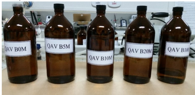
Figura 35 - Misturas de querosene QAV-1 com ésteres leves de biodiesel de óleo de amêndoa de macaúba, na proporção de 5, 10 e 20 %
