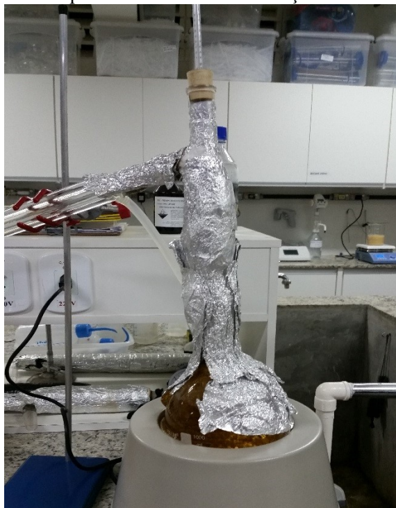
Figura 29 - Aparelho utilizado na destilação dos biodieseis
