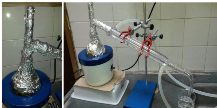
Figura 2. Aparelho utilizado na destilação do biodiesel de babaçu Figure 2. Devices used in the distillation of babassu biodiesel
