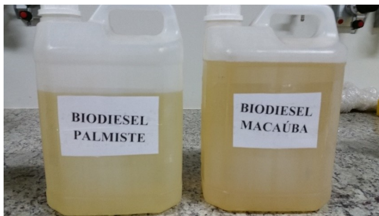
Figura 22 - Biodiesel produzido através da utilização de óleo de palmiste e de amêndoa de macaúba
