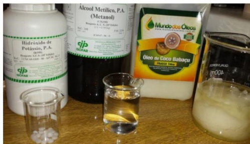
Figura 1. Materiais utilizados na produção do biodiesel de Óleo de Babaçu. Figure 1. Materials used in the production of babassu oil biodiesel
