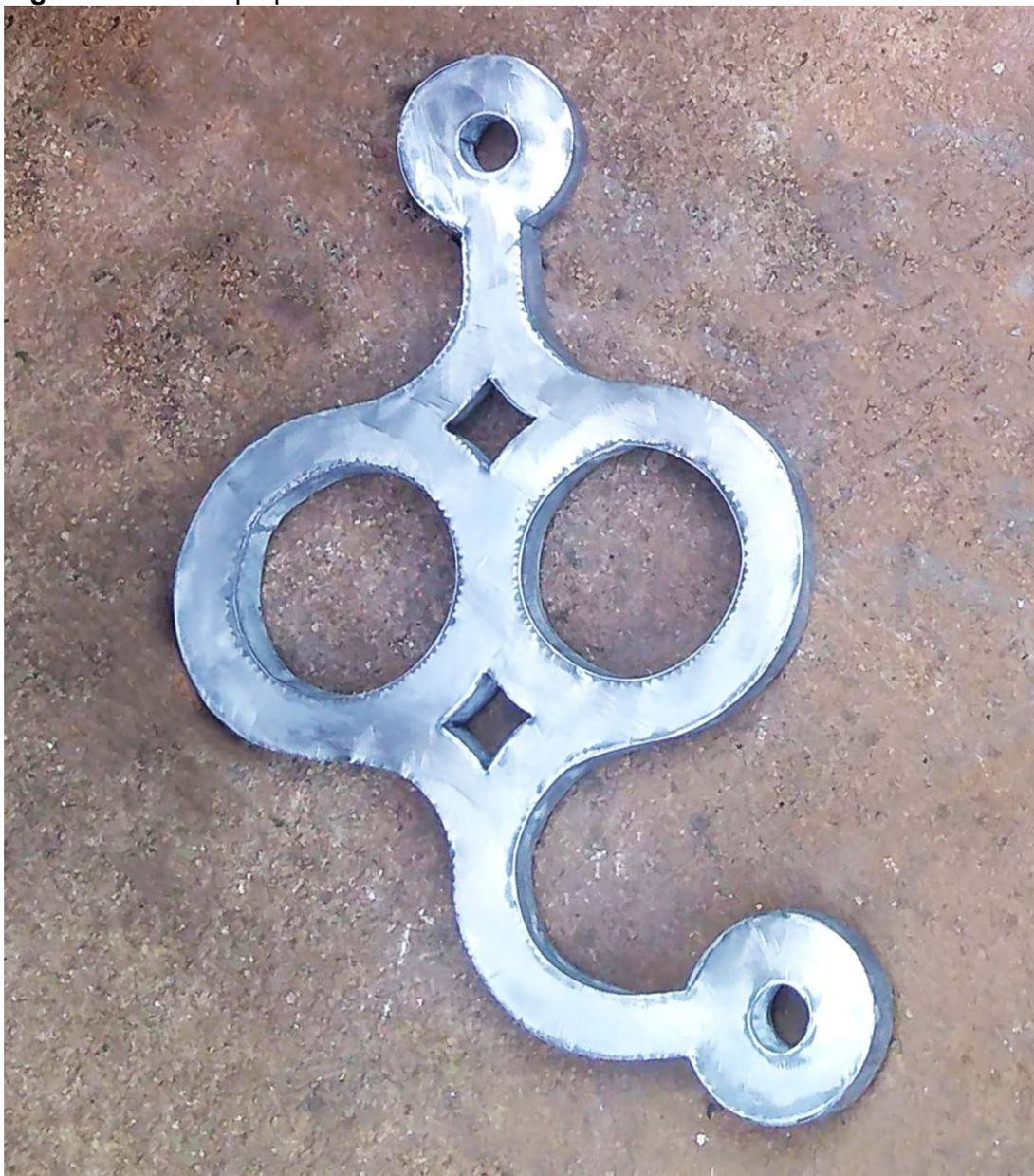
Devido à técnica de solda branda ser frágil, houve algumas quebras de soldas nos protótipos no momento da pintura (**Figuras 28 e 29**) e ao instalar as peças nos painéis de MDF. A razão seria que as porcas e arruelas exerceram pressão contra fase externa do painel de MDF, e isso ocasionou trincas na superfície do protótipo e o rompimento dos parafusos. Por essa razão, foi deixado de lado e substituído por peças em MDF 15 mm, cortados a laser,
