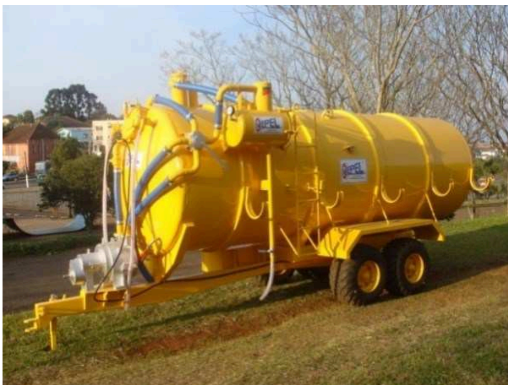
Figura 8 – Rio Verde: tanques para transporte e distribuição de dejetos, 2017
