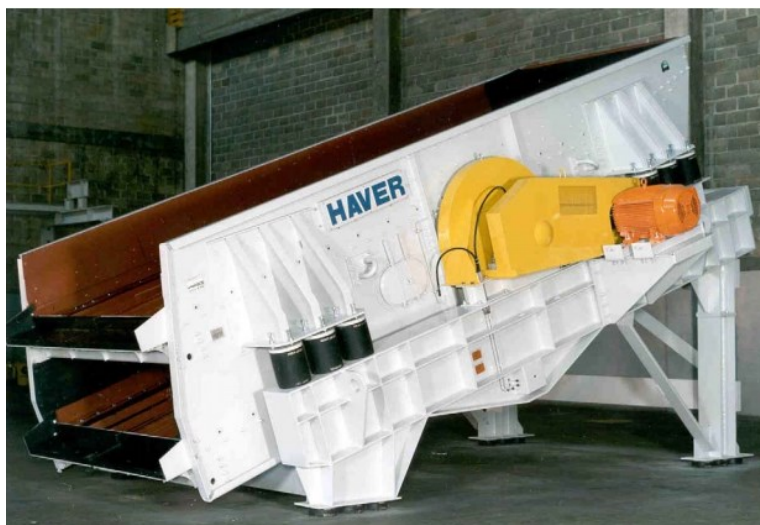
Figura 9 - Peneira vibratória de acionamento excêntrico
