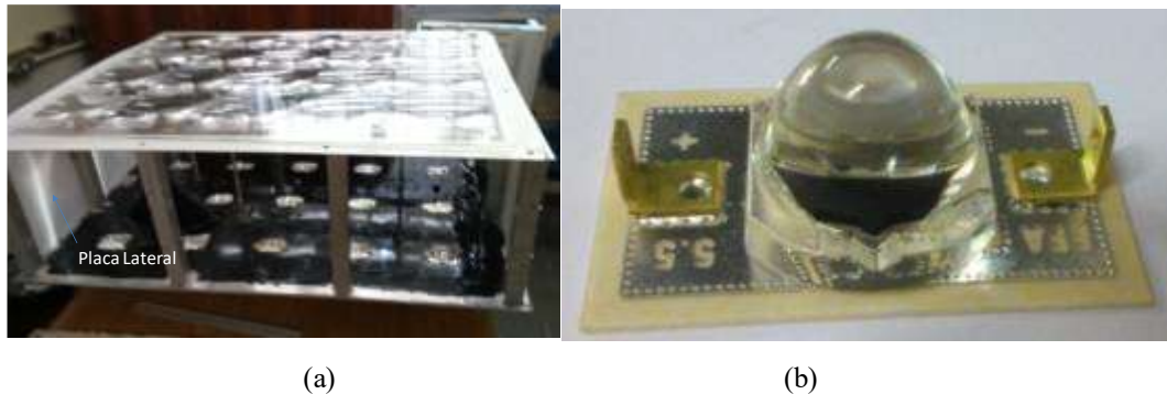
Figura 10 – Painel desenvolvido e células fotovoltaicas com concentração.
