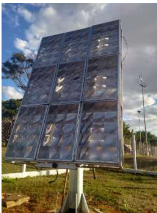
Figura 12 – Protótipo do sistema de geração fotovoltaica com rastreamento solar.
