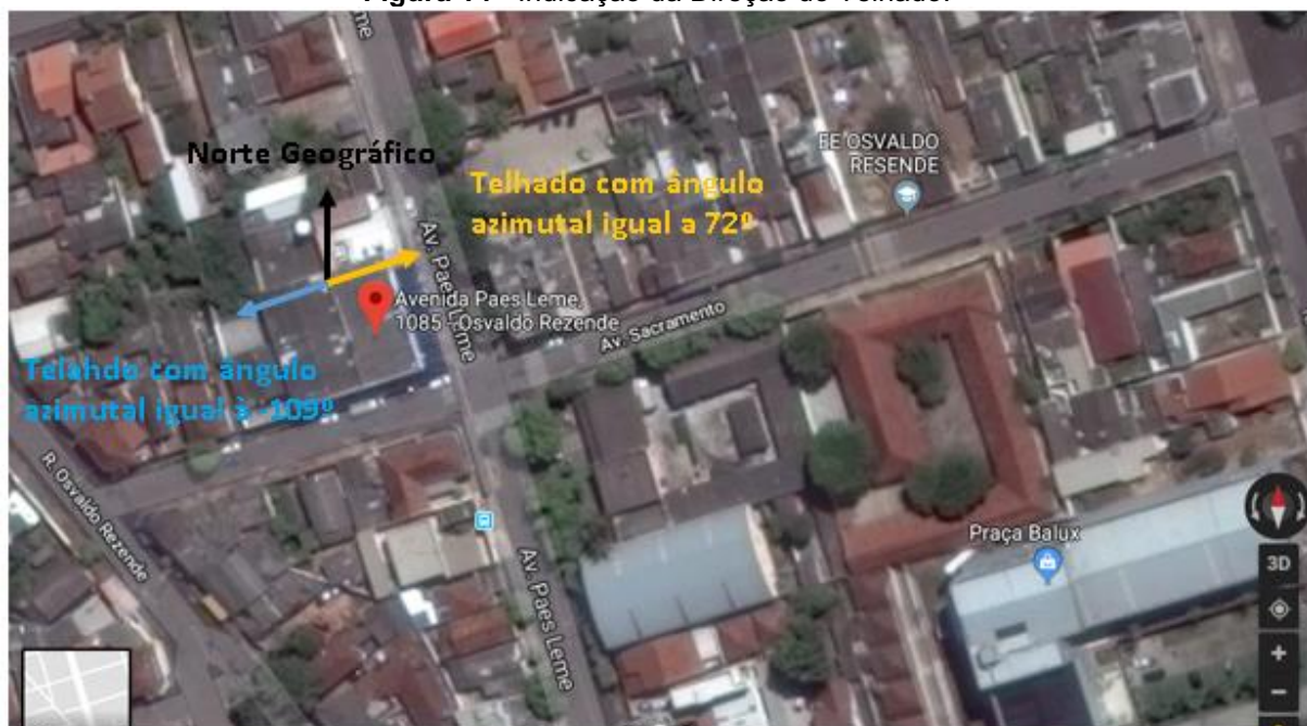
Figura 14 - Indicação da Direção do Telhado.
