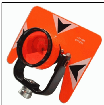
Figura 29 – Prisma utilizado no levantamento com estação total
