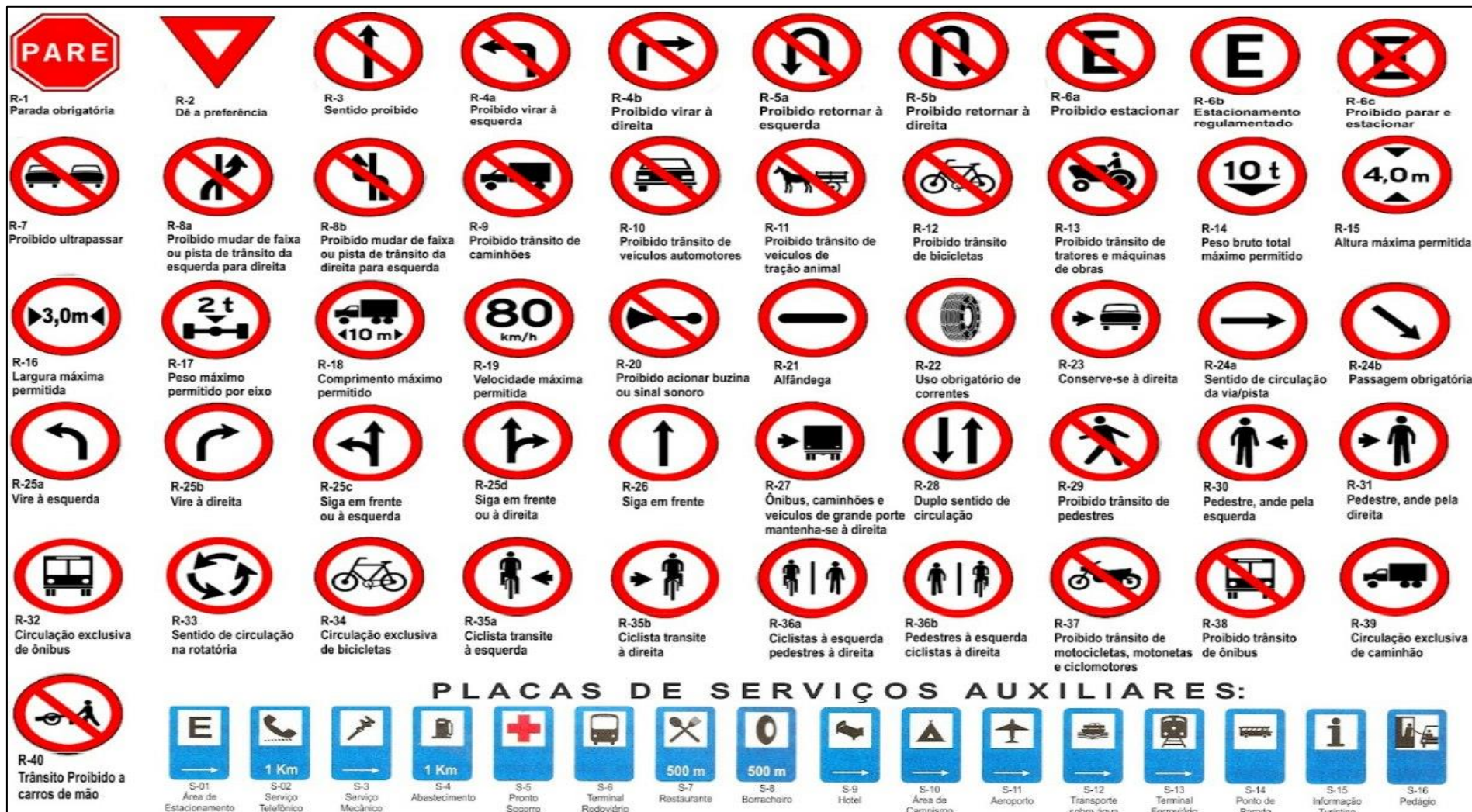
Figura 14 - Sinais de regulamentação
