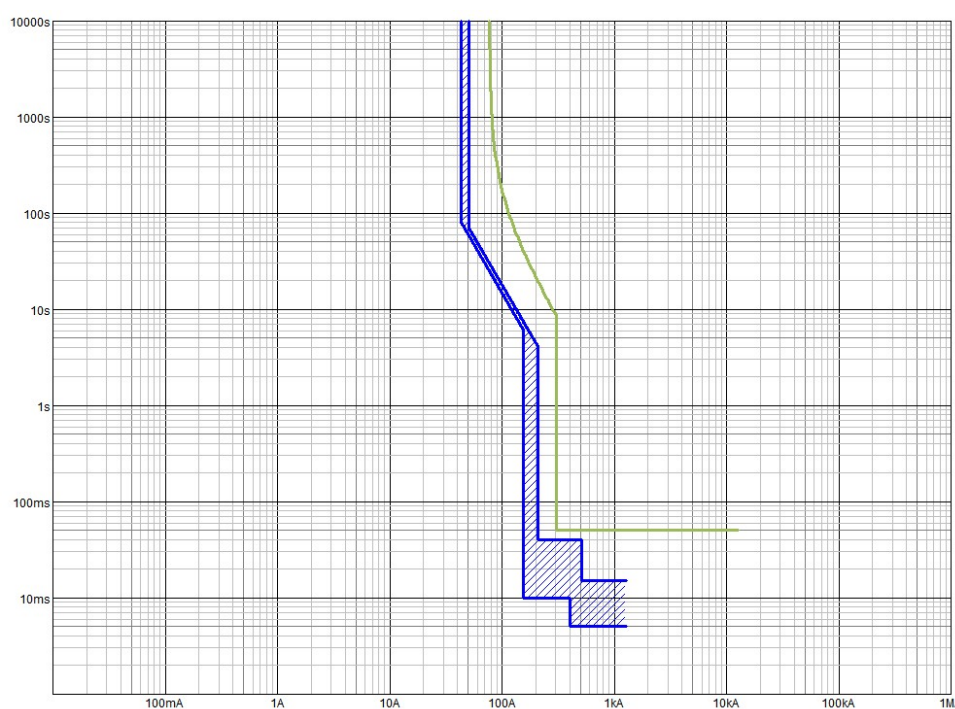
Figura 6-11 Coordenação dos disjuntores.
