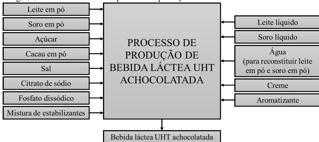
Figura 7 – Entradas e saídas do processo de produção de bebida láctea UHT achocolatada.
