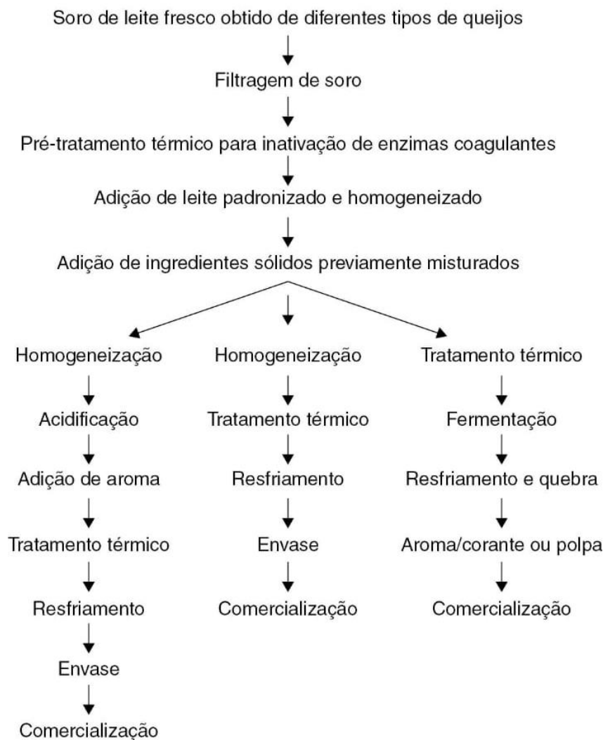
Figura 3 - Processo de fabricação geral de bebida láctea acidificada, pasteurizada e fermentada.
