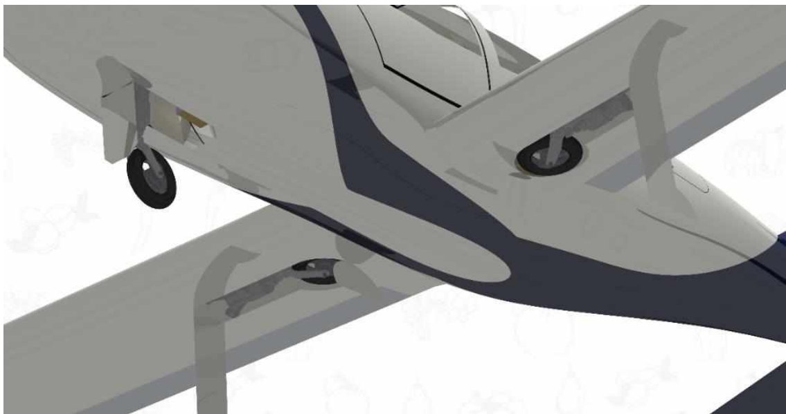
Figura 43. Configuração da aeronave com o trem de pouso principal recolhido
