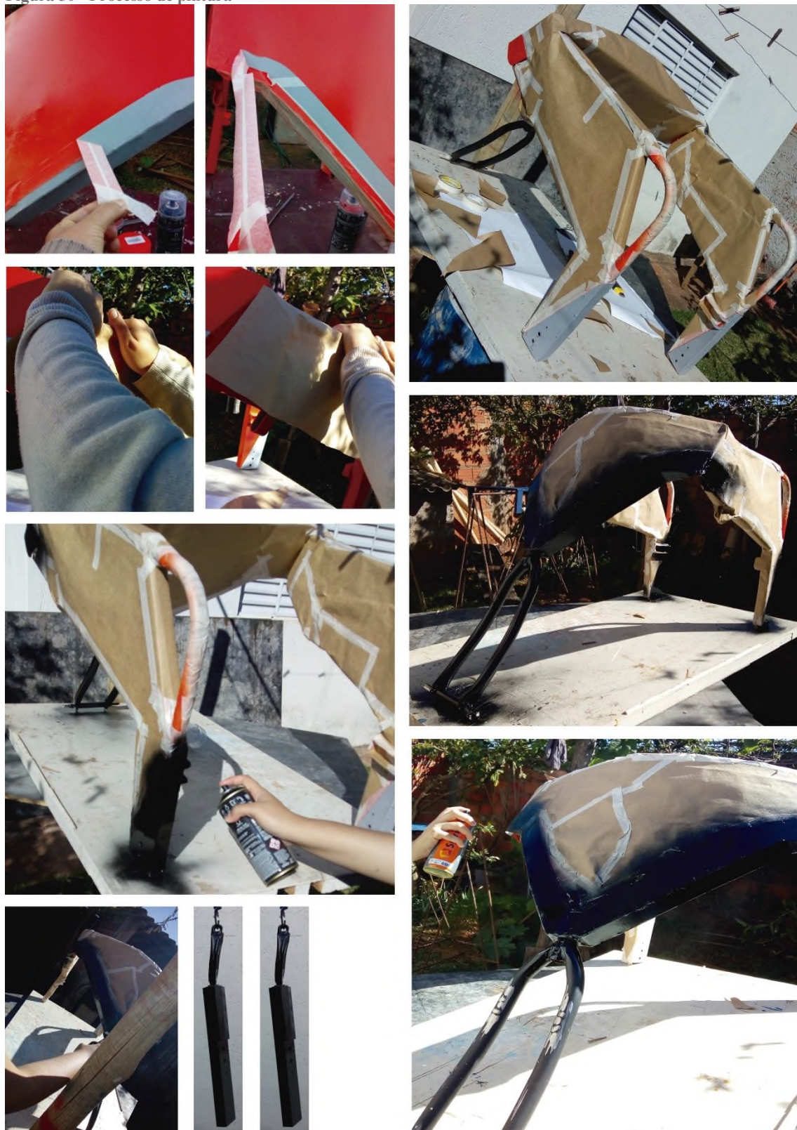
Figura 50 - Processo de pintura
