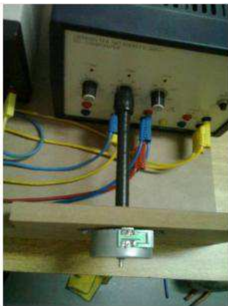
Figura 10 – Acoplamento entre motor de passo e potenciômetro.
