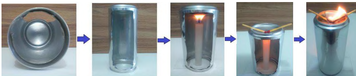
Foto 8 Experimento representando a condução de calor. Fonte: Própria
