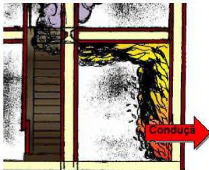
Figura 4 Transferência de calor por condução através da parede Fonte: (OLIVEIRA FILHO, 2009, p. 67)
