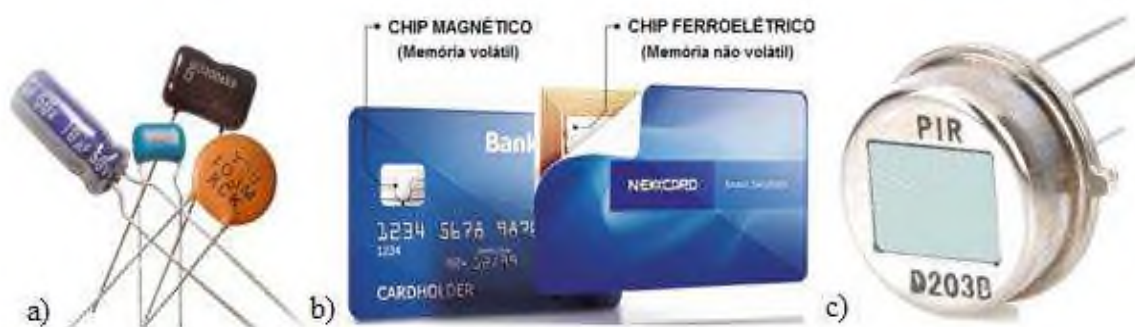
Figura 7: Representação dos materiais com propriedades ferroelétricas - a) capacitores; b) memória não-volátil e c) sensor piroelétrico. Fonte: Adaptado do site GFeMM.
