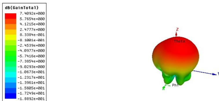
Figura 30 – Ganho em 3D da antena número 02 com nível de iteração 0
