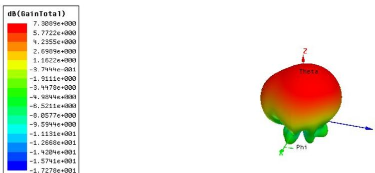
Figura 37 – Ganho em 3D da antena número 03 com nível de iteração 1
