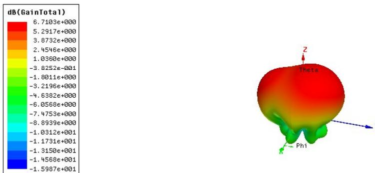
Figura 36 – Ganho em 3D da antena número 03 com nível de iteração 0
