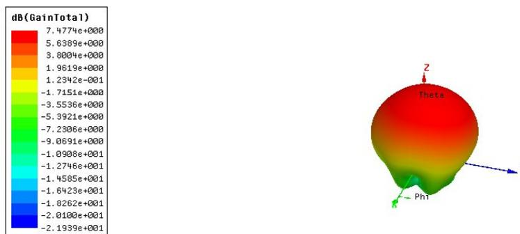
Figura 24 – Ganho em 3D da antena número 01 com nível de iteração 0
