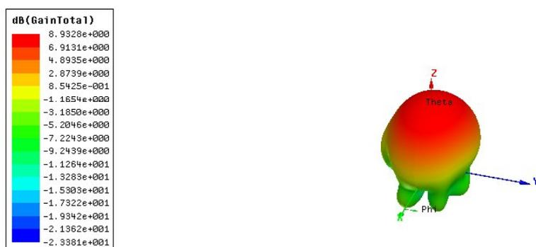
Figura 31 – Ganho em 3D da antena número 02 com nível de iteração 1
