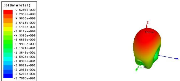
Figura 25 – Ganho em 3D da antena número 01 com nível de iteração 1
