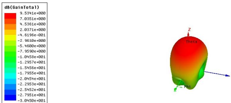
Figura 26 – Ganho em 3D da antena número 01 com nível de iteração 2
