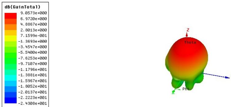
Figura 32 – Ganho em 3D da antena número 02 com nível de iteração 2
