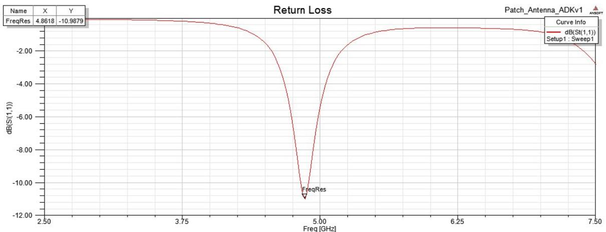
Figura 21 – Perda de retorno da primeira antena com nível de iteração 0
