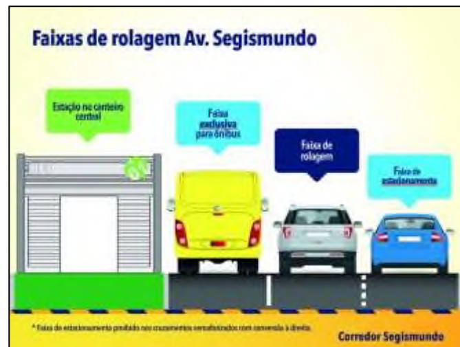
Figura 2 – Faixas de rolagem e estação de transbordo da Avenida Segismundo Pereira
