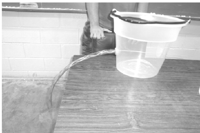
Figura 9: Princípio de funcionamento da fibra óptica
