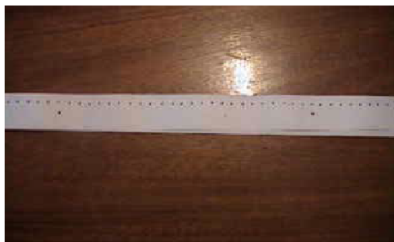
Figura 21: fita de papel com marcas, feitas na queda
