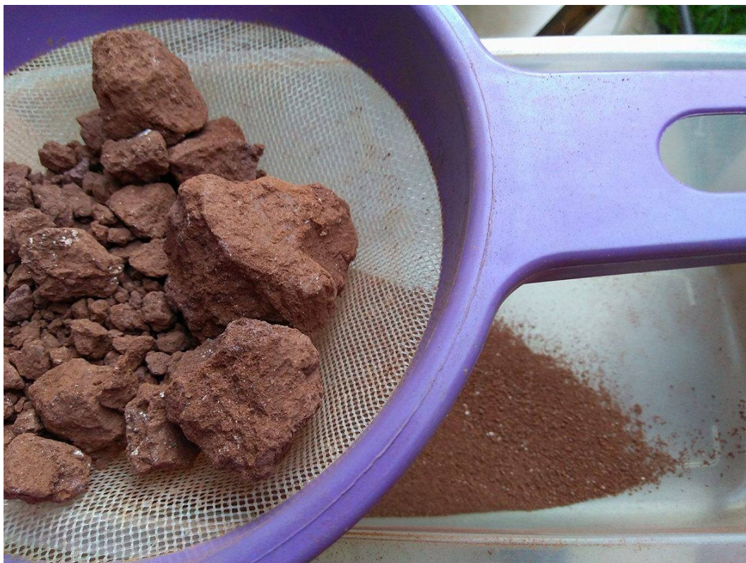
Figura 13: Processo de refinamento, purificação e separação de possíveis rejeitos, Como as raízes e pedras da terra, 2017.
