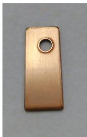
Figura 11: Modelo das placas de cobre utilizado nos testes de corrosão por imersão em biodiesel.
