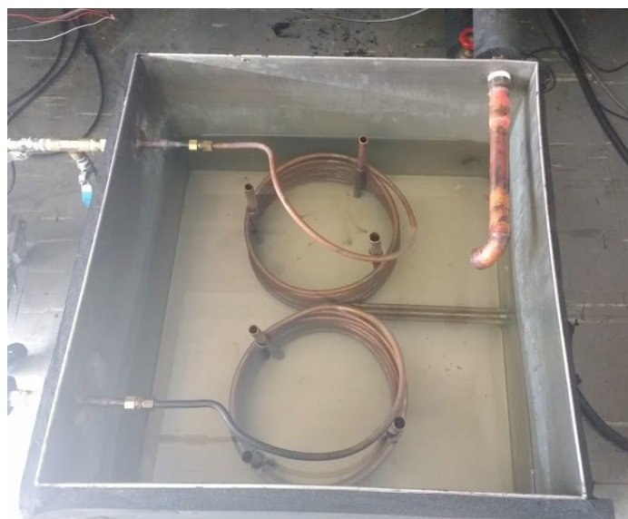
Figura 3.9 - Banho térmico e serpentina
