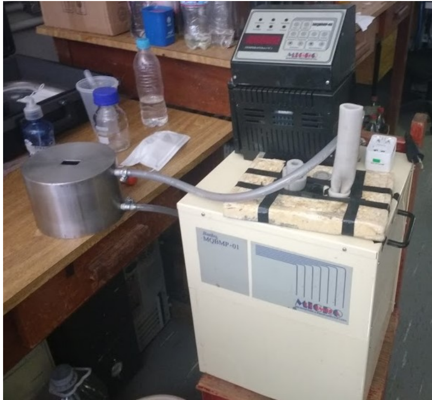
Figura 3.2 - Recipiente onde é realizada a medida de condutividade térmica (esquerda) e banho térmico (direita)
